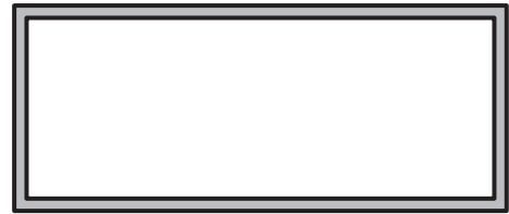
TUBO RECTANGULAR 60 x 25 x 1,5 mm. Perfil: MC-080 Peso: 0,664 Kg/m
