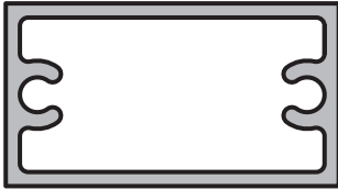
PARANTE REFORZADO Perfil: 2637 Peso: 0,648 Kg/m
