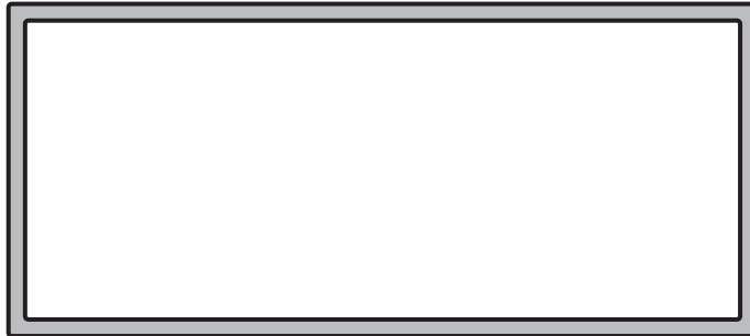
TUBO RECTANGULAR 90 x 40 x 2 mm. Perfil: 4833 Peso: 1,361 Kg/m Matriz: PC4833
