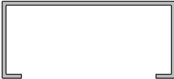
CANAL DE 90 x 40 x 2 mm. Perfil: 4834 Peso: 0,982 Kg/m
