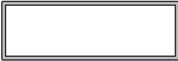
TUBO RECTANGULAR 76 x 25 x 1,6 mm.
