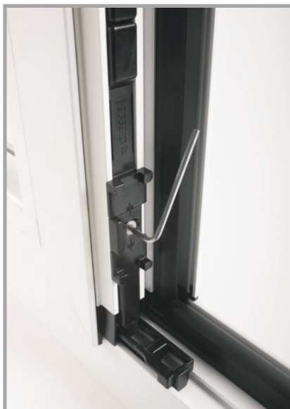
Pasador inferior con llave de 2,5 para la regulación del encuentro
